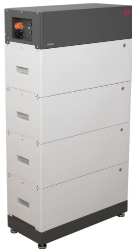
LVS 16.0 (4 Module + PDU. Max. 64 Module in 16 Türmen je System)
